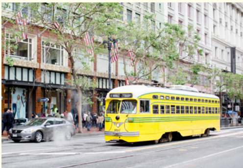
Ein Großraumstraßenwagen entwickelt in den 1930er Jahren in den Vereinigten Staaten. Es handelt sich um den Triebwagen 1057, Typ PCC.
