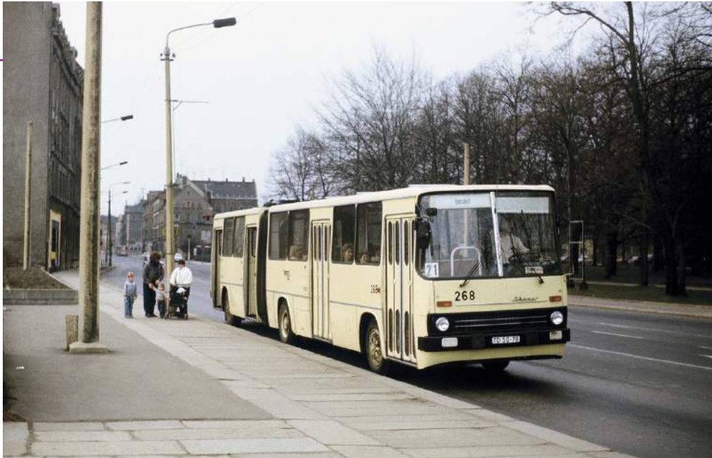
3 GELENKBUS VOM TYP IKARUS 280. HIER IN FRISCHER LACKIERUNG NACH SO GENANNTER GENERALREPARATUR IN HALLE AUF DER LINIE 21 IN RICHTUNG EBERSDORF AN DER HALTESTELLE PIONIERHAUS, DER HEUTIGEN HALTESTELLE RICHARD-HARTMANN-PLATZ.
